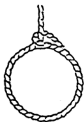
SISTEMAS INCORRECTOS EL CABLE SE PUEDE CORTAR
