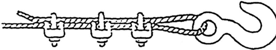
Sistema incorrecto.- Usar un guardacables para aumentar la resistencia del ojo y reducir el desgaste del cable.
