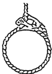
SISTEMAS INCORRECTOS EL CABLE SE PUEDE CORTAR
