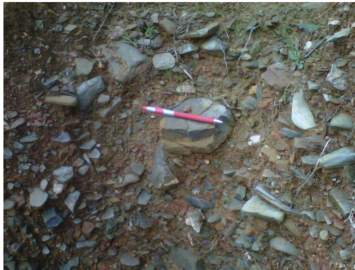
Foto 4 y 5. Detalle de suelo de recubrimiento aluvial afectado por erosión hídrica debido a una fuga importante de la conducción existente al norte de la parcela.
